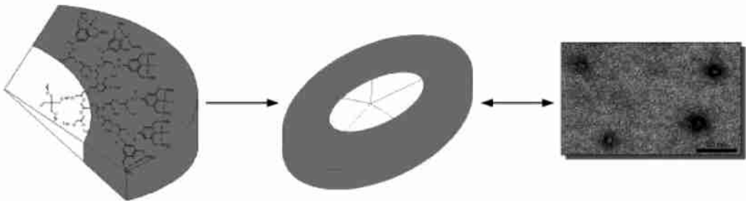
图 3 壳-核形超支化聚缩水甘油醚聚集态结构二维模型
